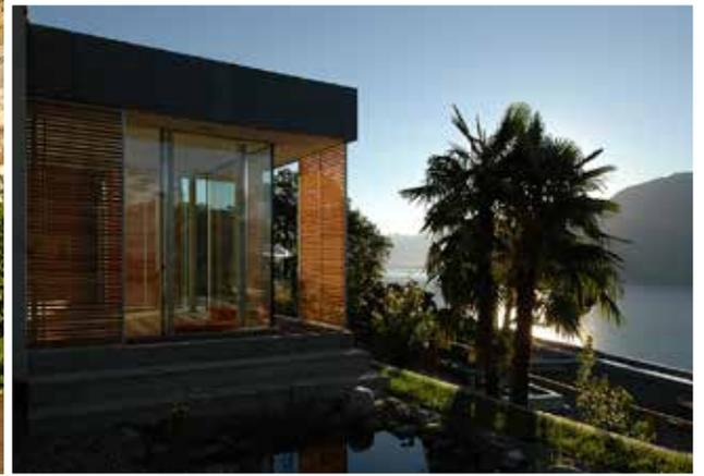
▲ Schiebeläden Larice Spezialanfertigung mit extra schmalen Rahmen. Formstabiler Aluminium Rahmen kombiniert mit Lärchenholzlamellen.
